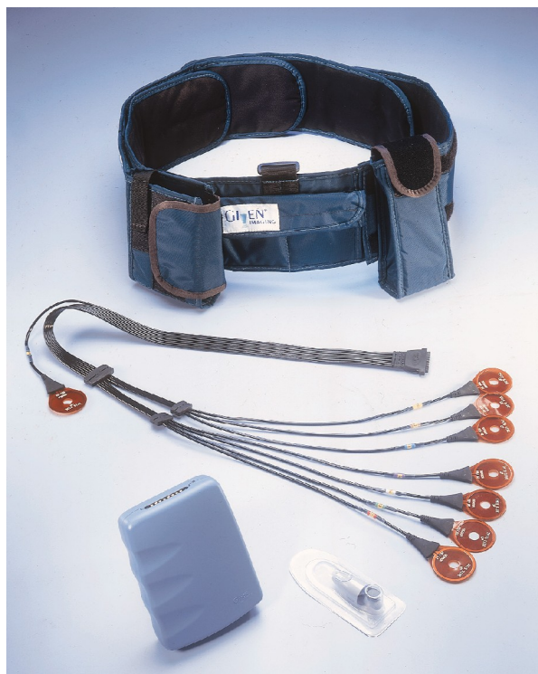
Rys. 2.2. Elementy systemu endoskopii bezprzewodowej: pas biodrowy, zestaw anten, odbiornik-rejestrator i kapsułka w opakowaniu (ilustracja udostępniona przez firmę GivenImaging ).
