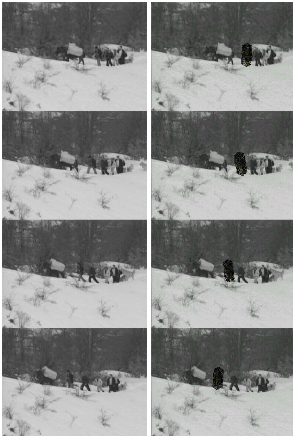
Rysunek 13. Śledzenie obiektu w obrazach rzeczywistych. Pokazano obrazy oryginalne (po lewej) oraz obrazy z nałożonym deformowalnym wzorcem wykorzystanym do śledzenia ruchu jednej z osób (po prawej).
