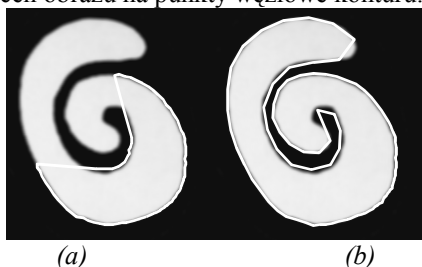
Rys.7. Przykład zastosowania aktywnego konturu do wyznaczania brzegu obiektu o złożonym kształcie: model z punktem środkowym (a) oraz model ciśnieniowy (b).
